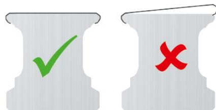
Rys. 5.45: Prawidłowo i nieprawidłowo zamontowana taśma osłonowa
